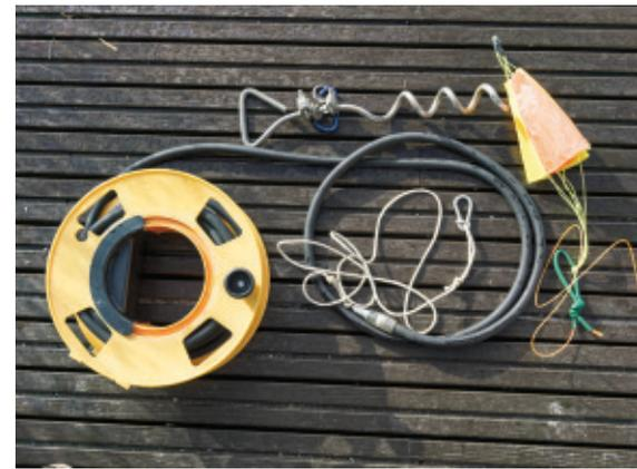
Die Hochstarteinrichtung (7,35-Meter-emc-vega-Scale-Gummi und 75 Meter Nylonseil) stellt der Veranstalter zur Verfügung.
